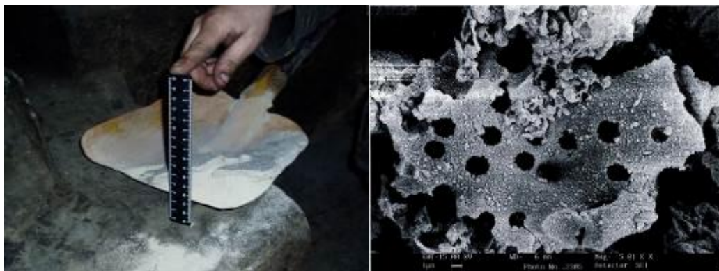
Рисунок 5. Зола от сжигания ВУТ и её микрофотография – поры размером 1..2 мкм
