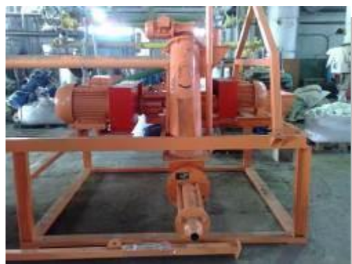
Рисунок 2. Гидроударный узел мокрого помола (ГУУМП)
